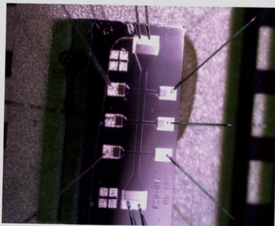
Obr. 6 Nakontaktovaná struktura typu Hall bar o šířce 100 mikronu, na níž je možné měřit AMR. Pro tento účel se použije vzorek s několika desítkami až stovek nm tlustou magnetickou vrstvou (Ga,Mn)As na galliumarsenidovém substrátu a přiložením magnetického pole v rovině vrstvy se ovládá směr magnetizace vrstvy. Na kontaktech podél vodivého kanálu se pak měří měnící se napětí. Celé měření se provádí nejlépe při teplotě kapalného helia, protože při pokojové teplotě již (Ga,Mn)As není feromagnetický.
